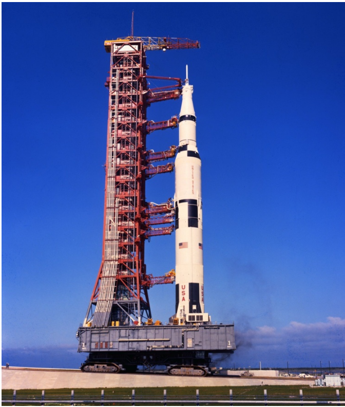
Le 20 mai 1969, la fusée Saturn V et sa tour de lancement sont transportées vers le pas de tir 39A à l'aide d'un engin chenillé appelé Crawler.
